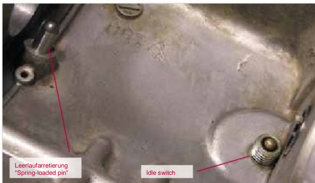
Figure 1-59: Neutral switch and Leerlaufarretierung
